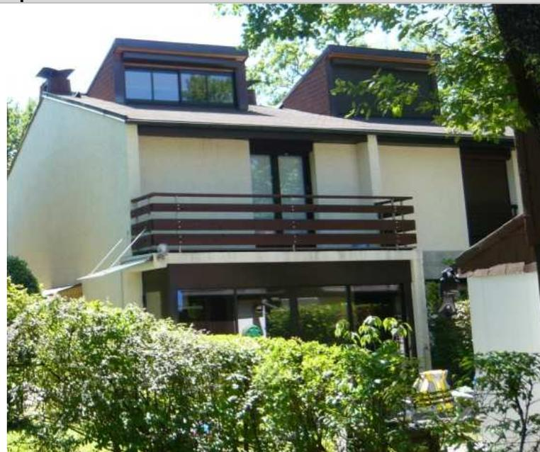
Véranda sous balcon existant ou à créer, d'une profondeur de 1,25 m ou 2,50 m. Elle sera constituée d'une baie coulissante à 4 vantaux vitrés sur toute la largeur de la façade, ou , uniquement dans la largeur de la baie existante, en conservant 2 parties maçonnées d'une largeur comprise entre 0,90 et 0,95 m à chaque extrémité et baie d'une largeur correspondant au percement d'origine, à 3 vantaux. Menuiserie en bois ou en aluminium, teinte brun foncé.
