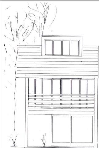
Les chien-assis sont limités à 1 par pan de toiture, placé au centre, baie à 4 vantaux, menuiserie de teinte brun foncé
